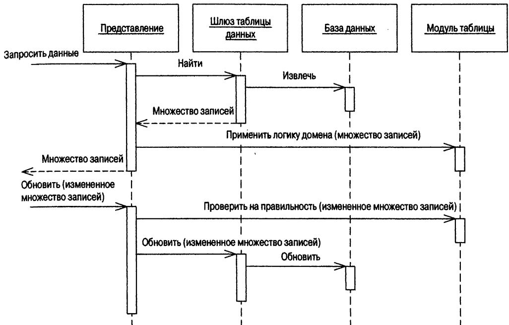
Рис. 9.5. Схема взаимодействия слоев кода с модулем таблицы
