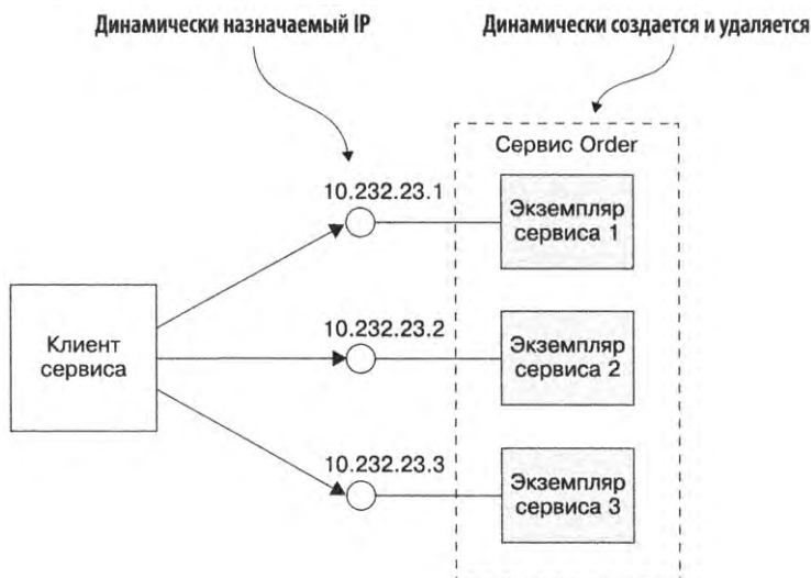
Рис. 3.4. Экземпляры сервисов имеют динамически назначаемые IP-адреса
