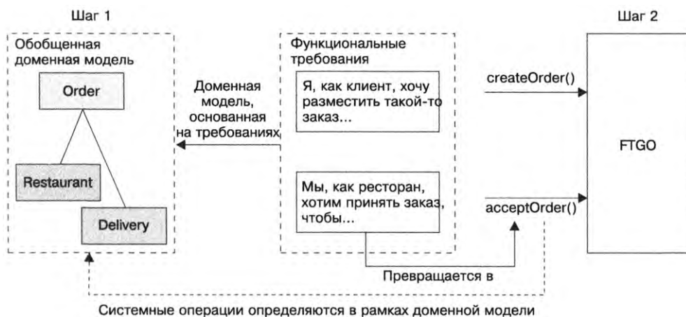
Рис. 2.6. Системные операции определяются на основе требований к приложению в ходе двухшагового процесса. На первом шаге создается обобщенная доменная модель. На втором шаге в рамках этой модели определяются системные операции
