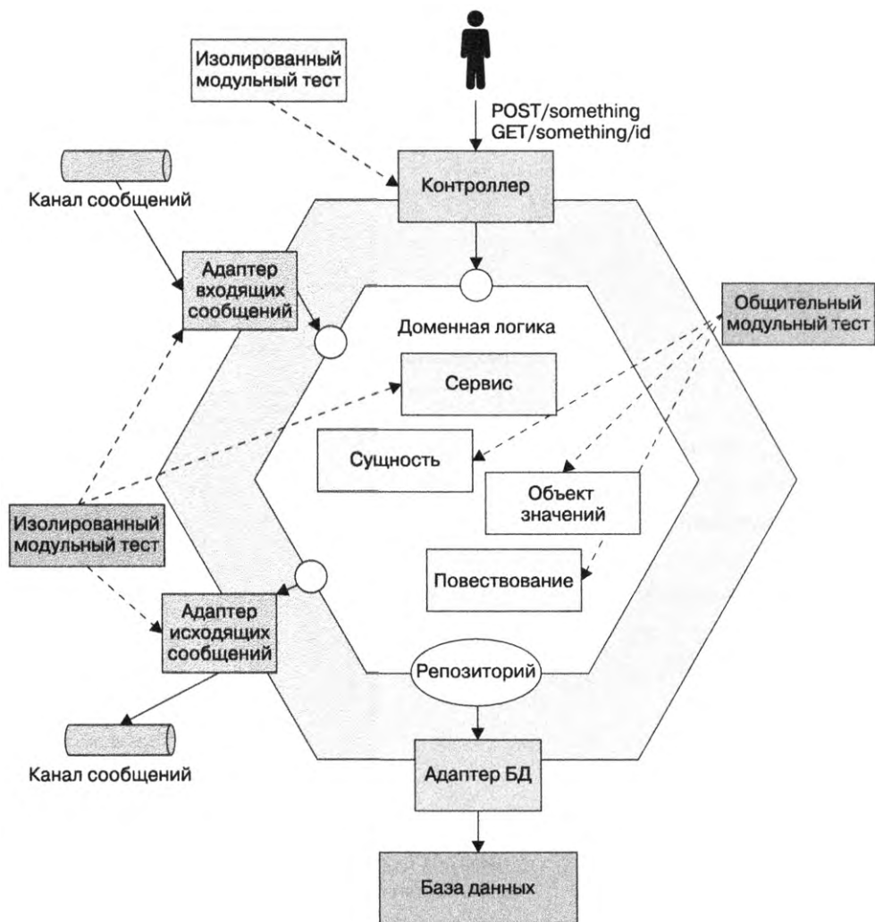
Рис. 9.11. Назначение класса определяет, какие модульные тесты нужно использовать — изолированные или общительные
