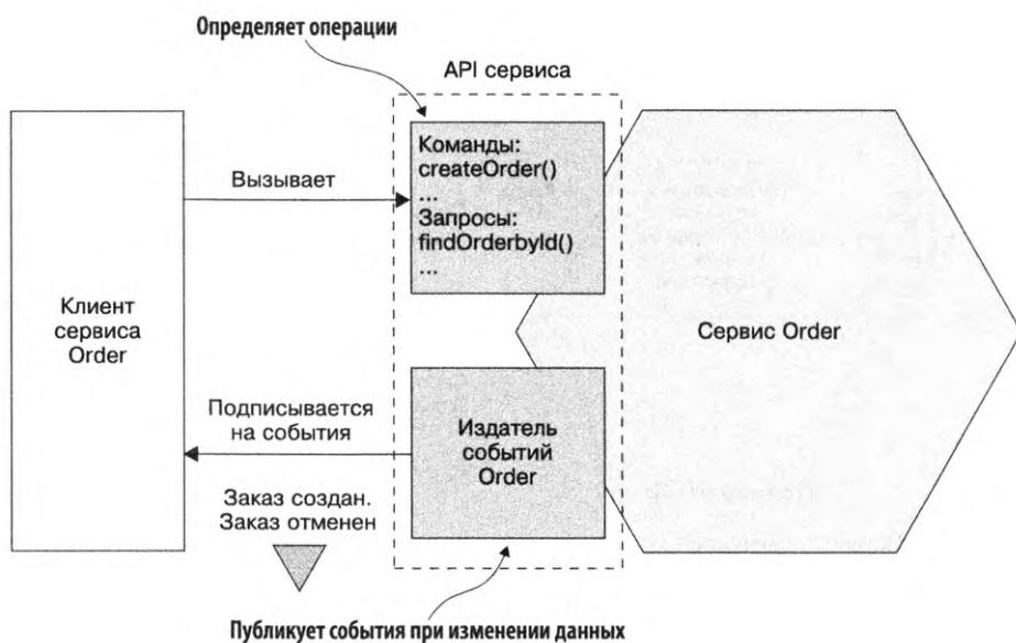
Рис. 2.4. Сервис обладает API, который инкапсулирует реализацию. API определяет операции, вызываемые клиентами. Существует два типа операций: команды (обновляют данные) и запросы (извлекают данные). При изменении своих данных сервис публикует события, на которые могут подписаться его клиенты
