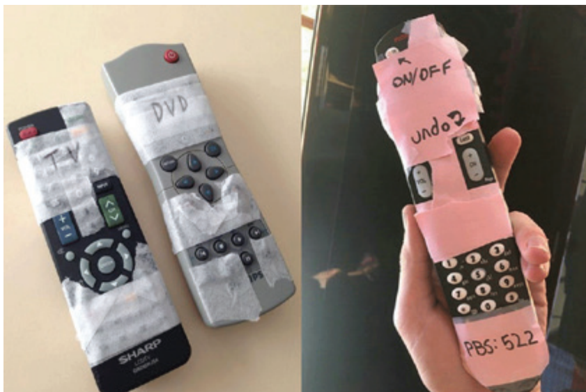
Рис. 3.3. Вручную «модифицированные» телевизионные пульты дистанционного управления с упрощенным «интерфейсом».
