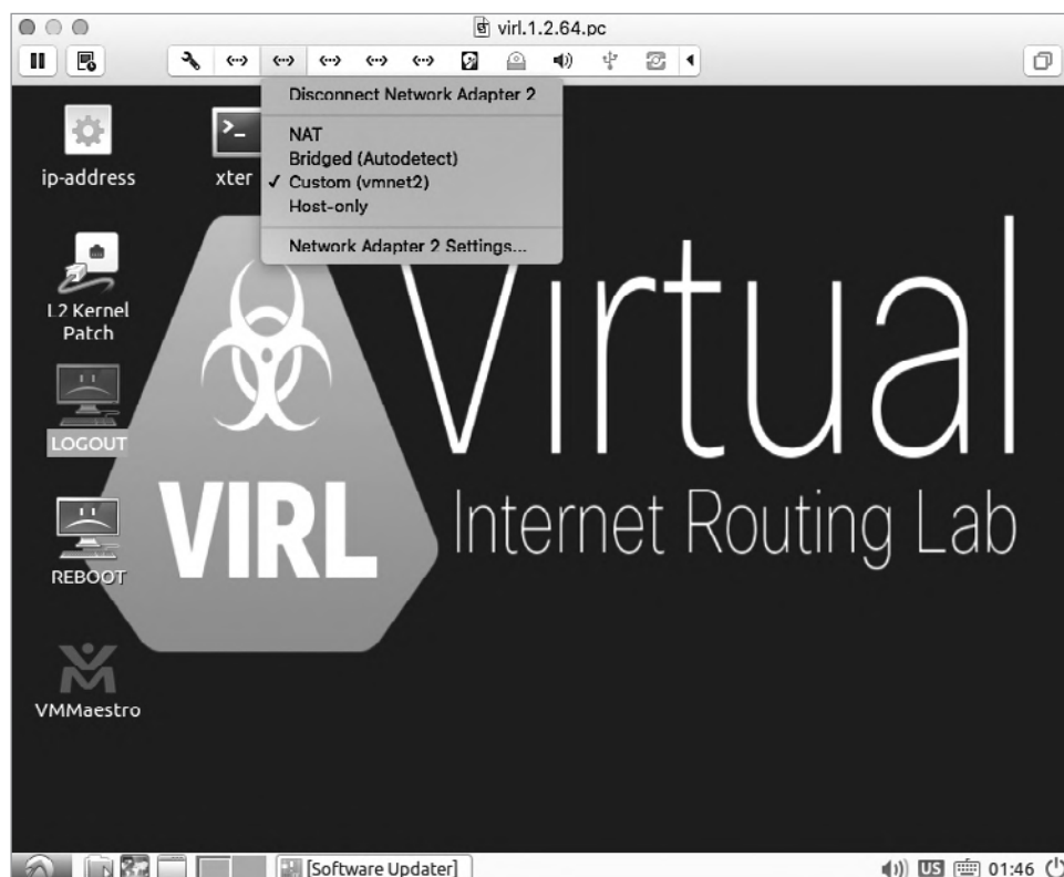
Рис. 2.3. Второй адаптер Ethernet VIRL соединен с VMnet2
