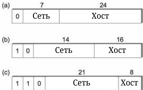
Рисунок 3.20. IP-адреса: (a) класс A; (b) класс B; (c) класс C.
