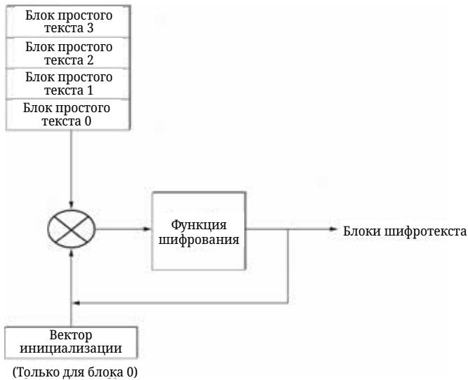
Рисунок 8.2. Цепочка блоков шифра.
