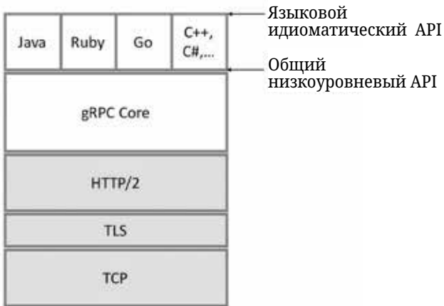
Рисунок 5.22. Ядро gRPC, уложенное поверх HTTP, TLS и TCP и поддерживающее множество языков.
